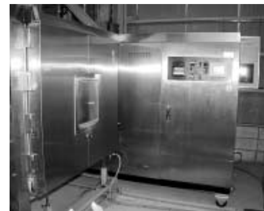
写真2 複合環境試験振動試験装置 (VS-5500-2202/IMV-671)
