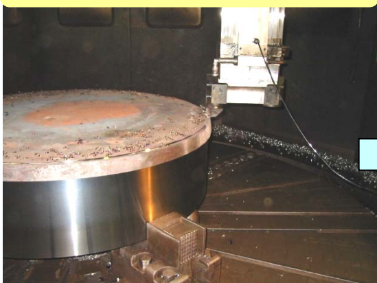
外径加工：断続重切削(鍛造肌)
