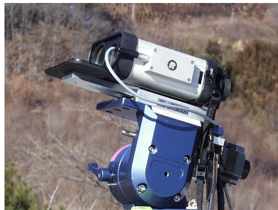
経緯台に載ったレーザー距離計 (RIEGL FG21-HA)
