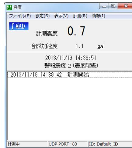
計測中に、「計測」→「計測終了」をクリックすると、計測が終了します。
